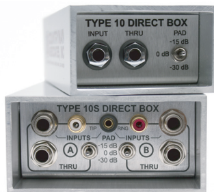
Direct boxes Type 10 (um canal) e Type 10S (estéreo).
